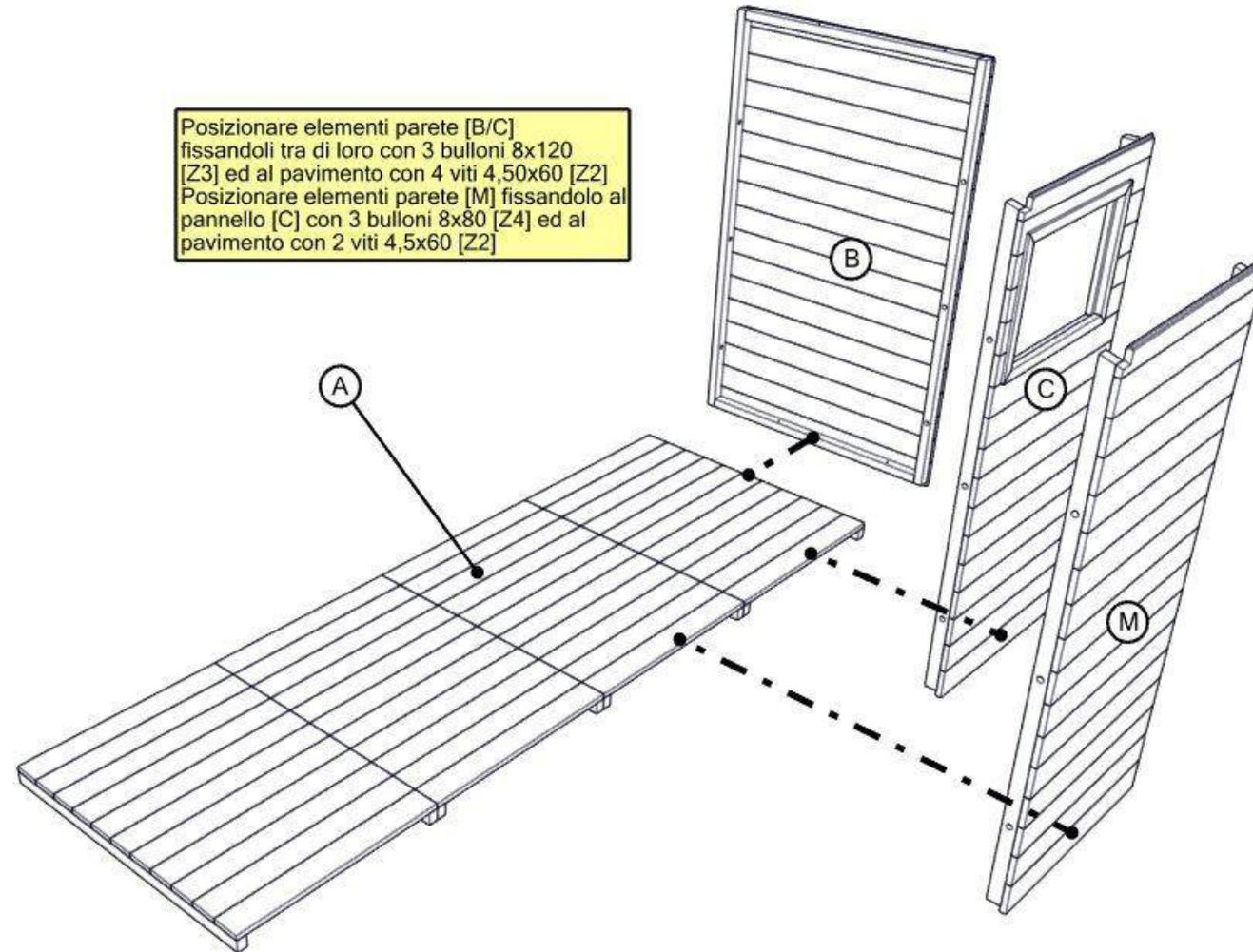
Posizionare elemento parete [M] fissandolo al pannello [M] con 3 bulloni 8x120 [Z3] ed al pavimento con 2 viti 4,5x60 [Z2]
