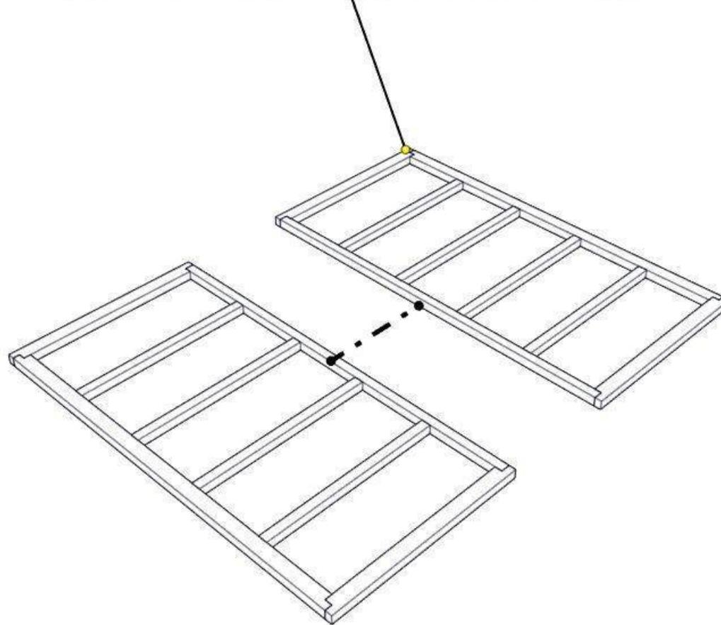
Posizionare elementi perlina [B/C] fissandoli al telaio pavimento [A] con 4 viti 4,50x60 [Z1]
