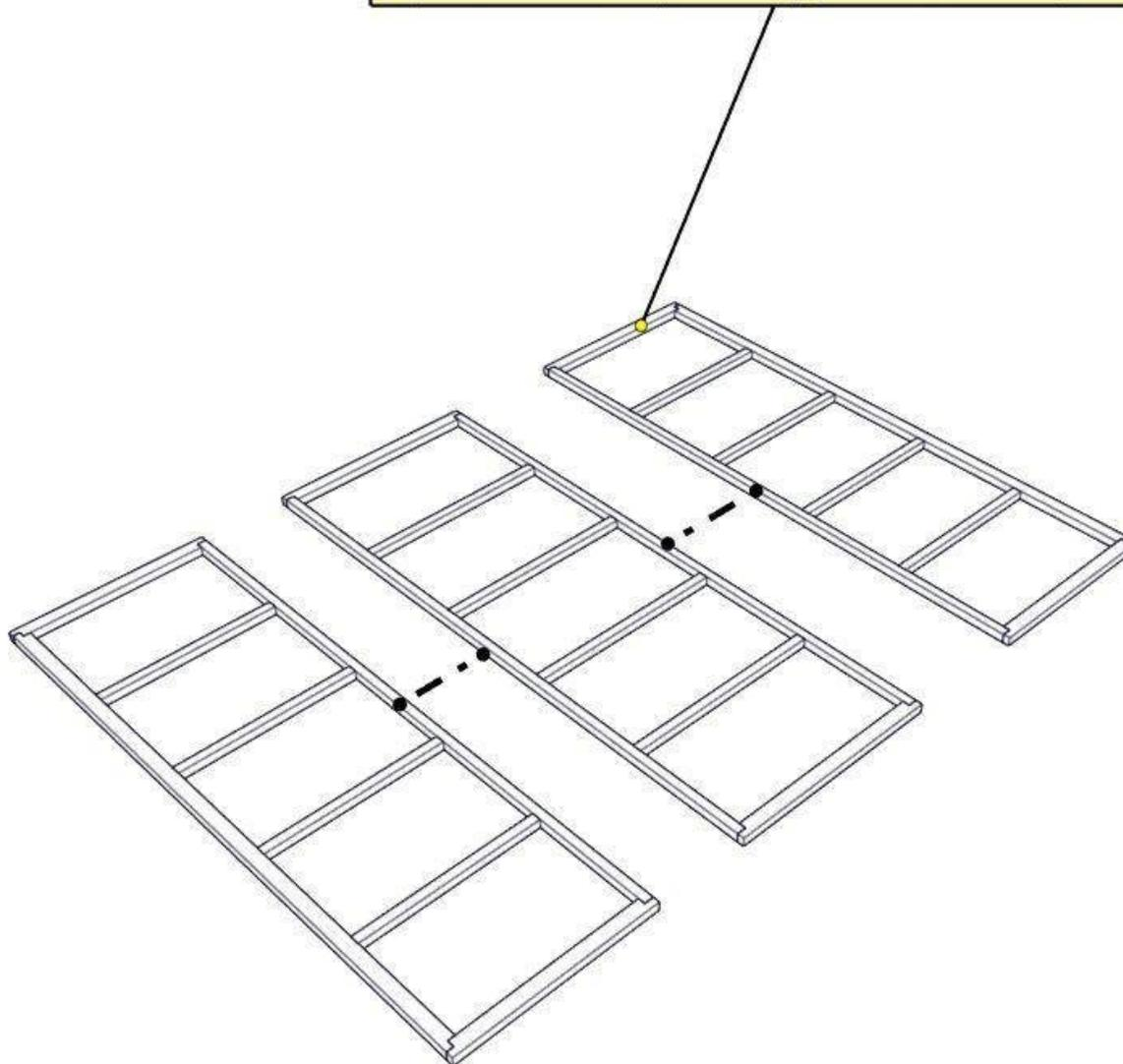
Posizionare elementi perlina [B/C] fissandoli al telaio pavimento [A] con 4 viti 4,50x60 [Z1]
