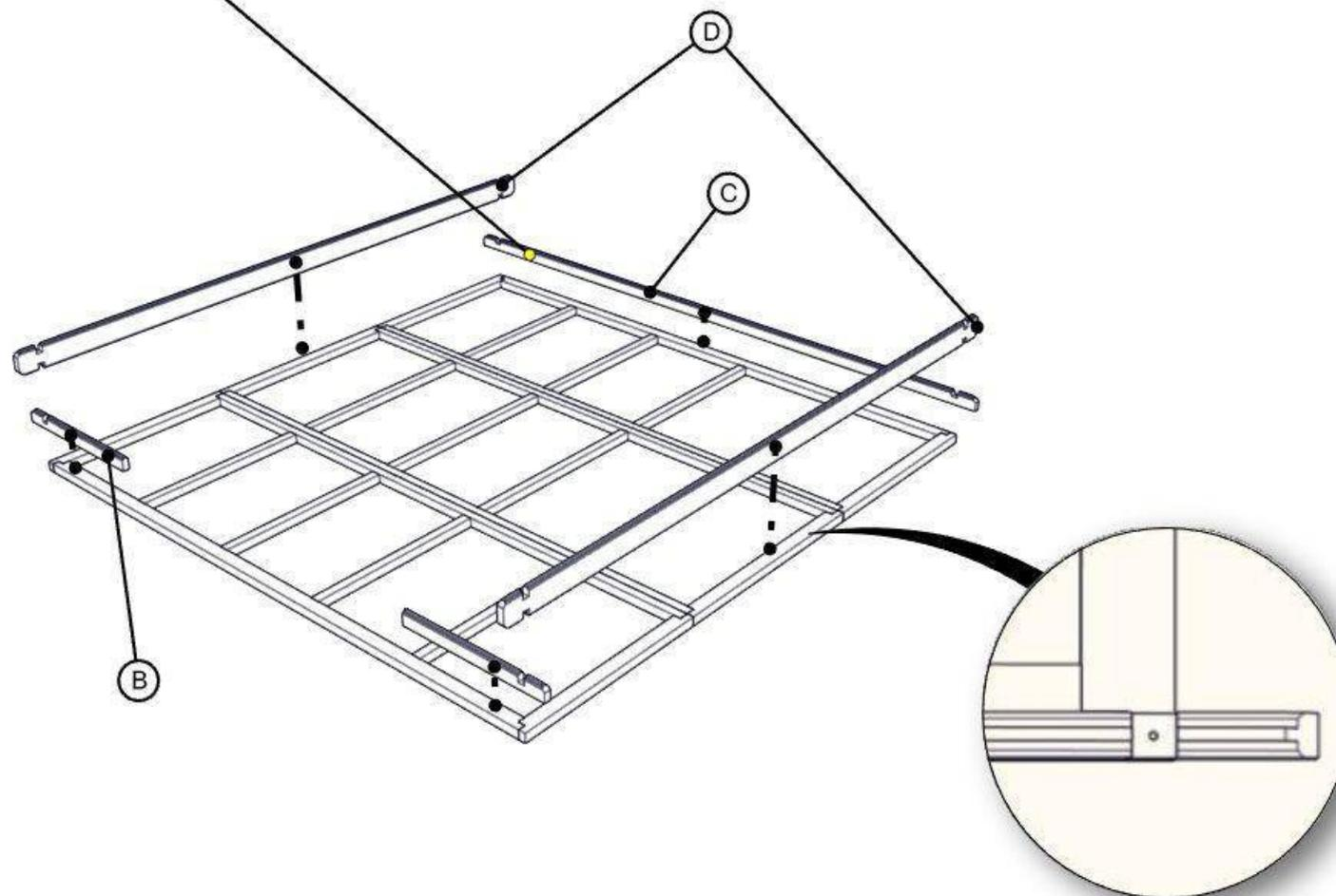
Posizionare e incastrare elementi perlina [E/D] per 6 strati iniziando con l'elemento perlina frontale [E] a DX poi con l'elemento perlina [D] laterale, posteriore, laterale ed infine l'elemento frontale SX [E]
