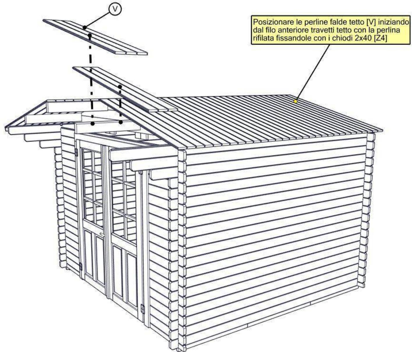
Fissare i frontalini anteriori/posteriori [V1] sulle parti anteriori e posteriori del tetto con 8 viti 4x40 [Z3], proseguire fissando i fregi finitura sul colmo anteriore/posteriore falda tetto [R] utilizzando 4 viti 4x40 [Z3] posizionare i rigolini [V2] e fissarli con 8 viti 4x40 [Z3]
