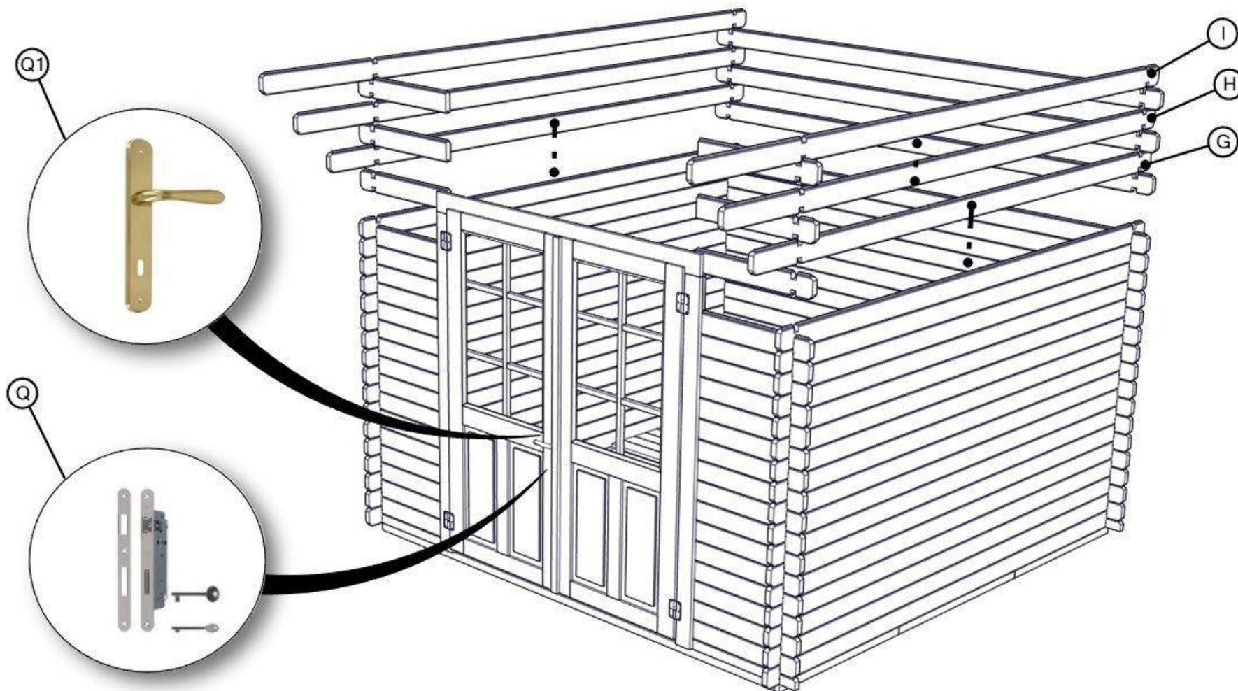
Posizionare e incastrare elementi perlina [G/H/I] incastrandoli con elementi perlina [D/E], togliere i rigolini fermavetro posizionare il plexiglass e riposizionare i rigolini [P] e fissarli con i chiodi, inserire la serratura [Q] nella sede e fissarla con due viti 4x 40 [Z3], fissare la maniglia [Q1] con 6 viti 3,5 x 20 [Z5] e fissare il contrasto [S] serratura sul montante porta fissandolo con 2 viti 4x 40 [Z3]
