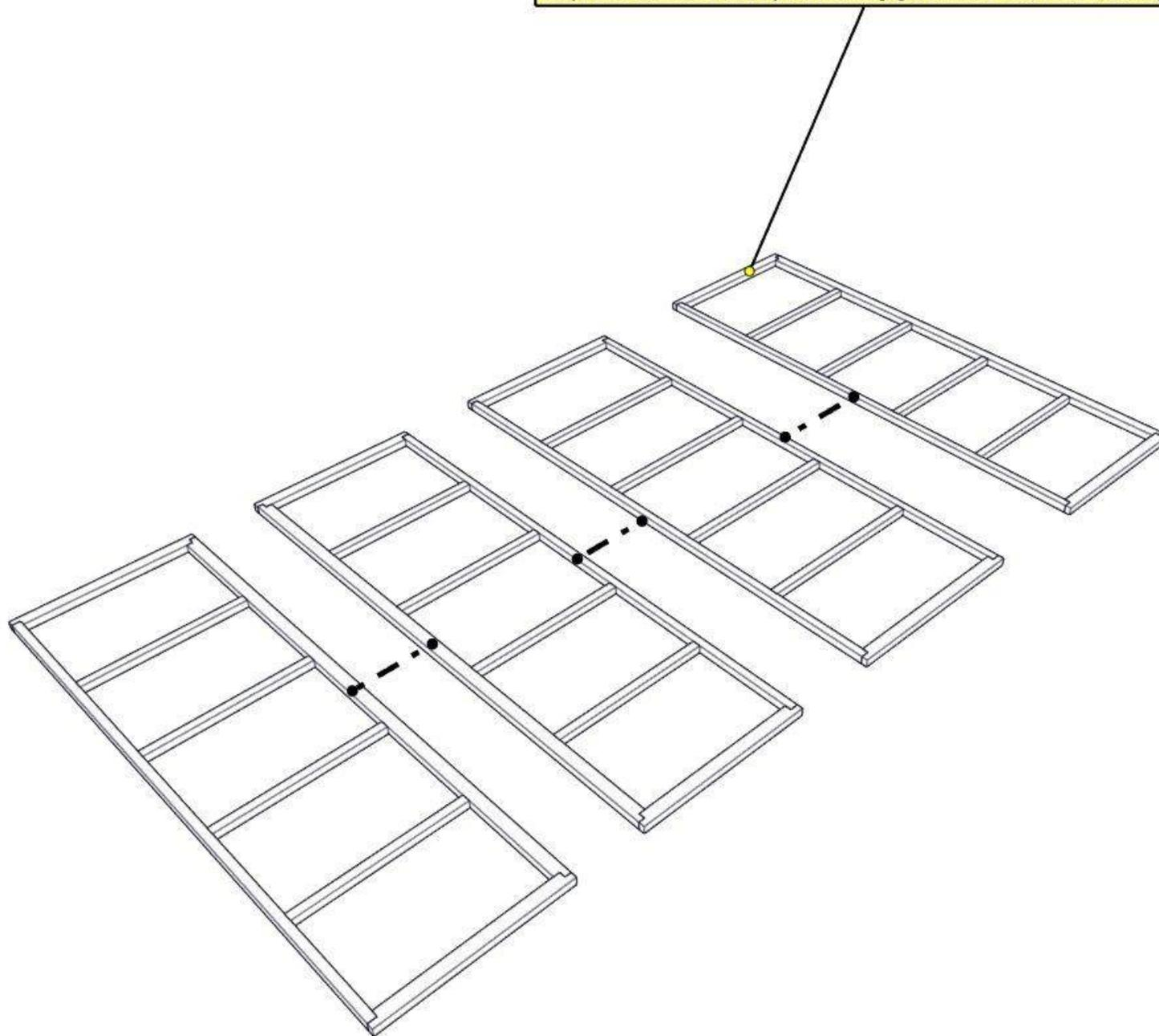
Posizionare elementi perlina [B/B1/C] fissandoli al telaio pavimento [A] con 4 viti 4,50x60 [Z1]
